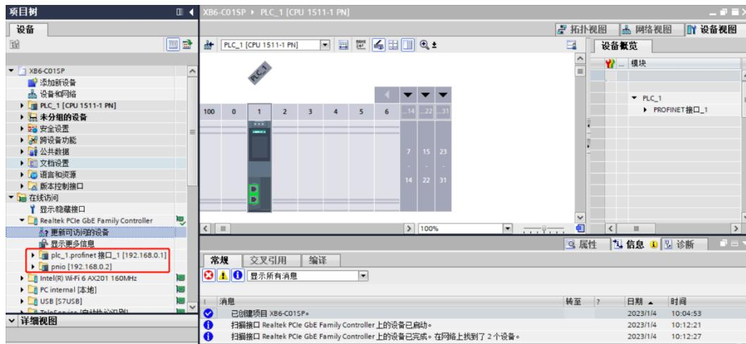
电脑的 IP 地址必须和 PLC 在同一网段，若不在同一网段，修改电脑 IP 地址后，重复上述步骤。
