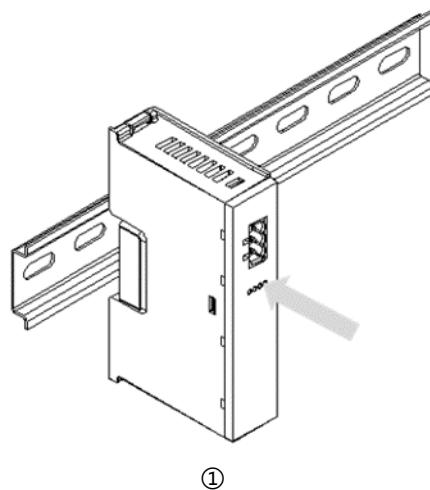
将电源模块导轨卡槽，
